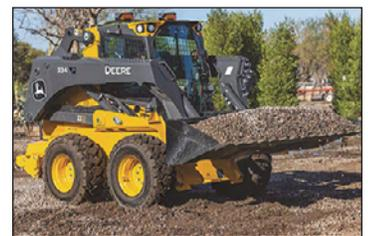
Axés sur le confort et les capacités de l'utilisateur, les nouveaux modèles de catégorie P sont dotés de postes de conduite plus grands et entièrement redessinés. Le nouveau poste de conduite est étanche, pressurisé et isolé du châssis afin d'améliorer le confort et la productivité de l'utilisateur. Cela signifie que le bruit extérieur sera réduit et que l'intérieur de la cabine est mieux protégé des éléments.
