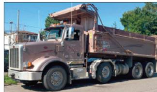
Moteur Paccar MX-13 455 hp. Transmission Allison 4500. Full lock. Essieu relevable SM 20 000 lb. Arrière 46 000 lb. Boîte Lagacé chauffante 20 pi. Freins arrière refait en neuf. Camion et inscription au registre peuvent être vendus séparément
