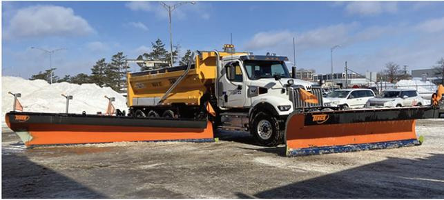
Le MTMD a lancé un projet pilote à la fin janvier pour tester une nouvelle machinerie dans la région de Québec, principalement sur l'autoroute 40 et l'autoroute Henri-IV. Il s'agit d'un camion de déneigement muni d'une aile de côté géante ayant une largeur de déblaiement de 8,3 m (27 pieds), permettant de déneiger simultanément deux voies de circulation.
