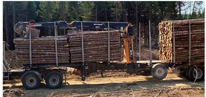
**Une semi-remorque équipée d'une autochargeuse offre plus d'autonomie, mais diminue la charge utile transportée d'environ 3 tonnes.**
