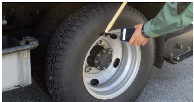
Yokohama a commencé à tester une nouvelle technologie qui utilise l'IA pour mesurer la pression de l'air à partir du son émis en tapant sur les pneus des camions et des bus.
