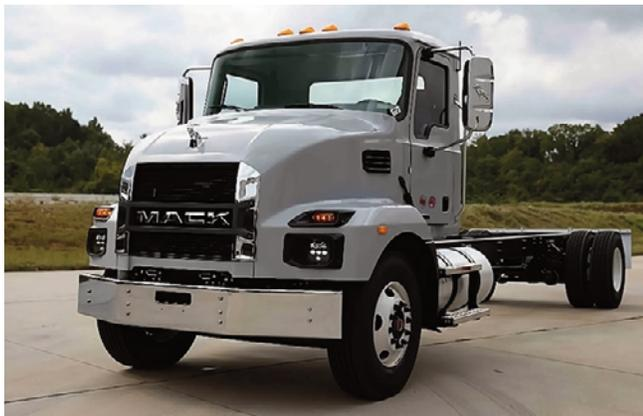
Mack Trucks a étendu sa gamme de la série MD avec un nouvel essieu arrière de 23 000 lb et un moteur Cummins B6.7 de 325 chevaux. Ce changement élargit sa polyvalence des camions de la série MD. L'essieu arrière de 23 000 lb accroît les applications sur le marché vocationnel, les déchets et la construction.
