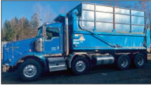
12 roues. Moteur Cummins, 359 175 km. Transmission automatique Allison. Boite Lagacé avec panneau à neige en acier.
