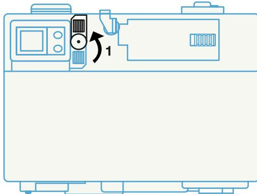
Klappen Sie die Kurbel (2) aus und drehen Sie sie in Richtung des Pfeils, bis der Widerstand beim Ziehen der Folie verschwindet.
