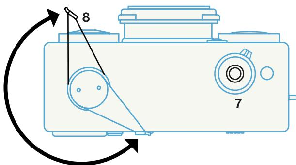
Vergewissern Sie sich, dass der Spannhebel bis zum Anschlag gezogen ist, wie in der Abbildung gezeigt, bis die Spitze des Hebels nach vorne zeigt.
