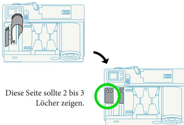
Schließen Sie die Rückseite noch nicht. Schalten Sie die Kamera ein und drücken Sie den Auslöser (7) fest bis zum Anschlag herunter. Ziehen Sie den Spannhebel (8) bis zum Anschlag.
